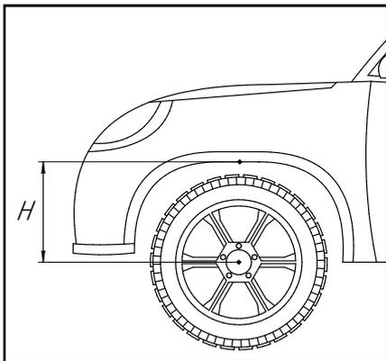
**ВНИМАНИЕ!** Измерения высоты необходимо делать сразу после установки новых элементов подвески и на инспекции 500 км. Измерения высоты проводятся по вертикали от центра ступицы колеса до нижней части арки крыла. Отсутствие параметров измерения высоты может повлиять на рассмотрение гарантийного случая. Гарантийный лист **ОБЯЗАТЕЛЬНО** должен быть заполнен при установке новой подвески. Невыполнение этого требования может повлиять на гарантию.
