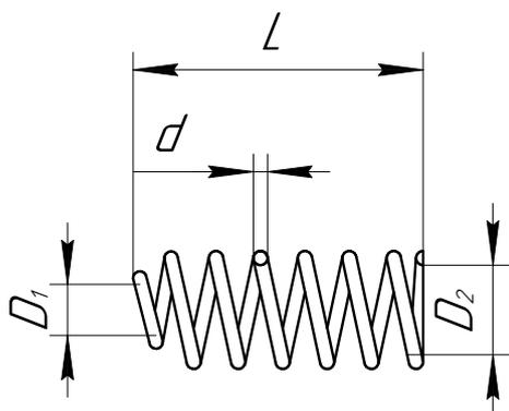
Буквенные обозначения на чертеже пружины:
